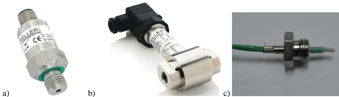
Rys. 2. Urządzenia pomiarowe: przetworniki ciśnienia a) bezwzględnego PAA-23SY, b) różnicowego PD-23, c) termopara typu T, pokryta teflonem
