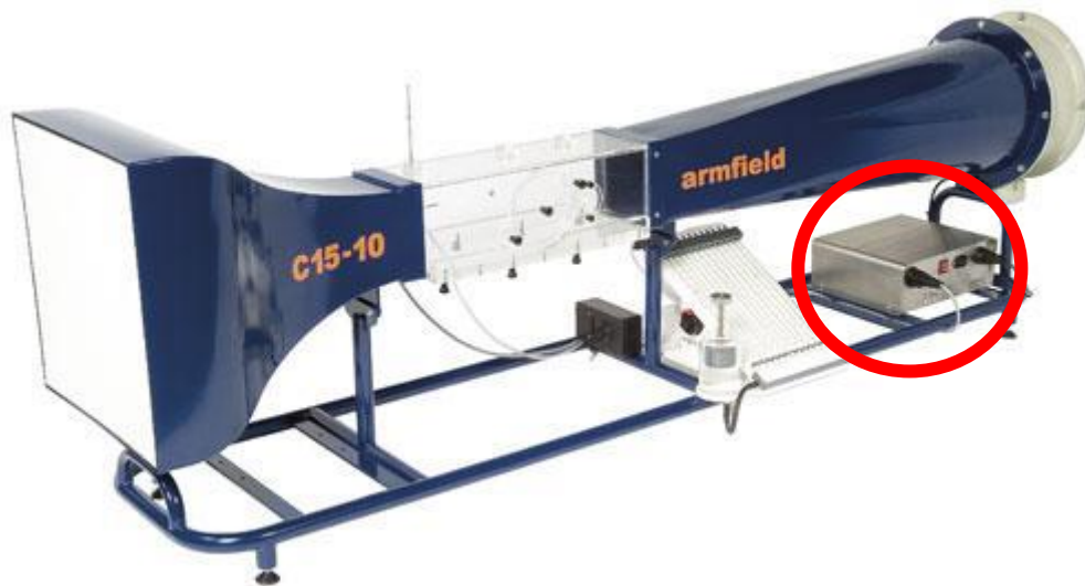
Rys. 1. Tunel aerodynamiczny C15-10
