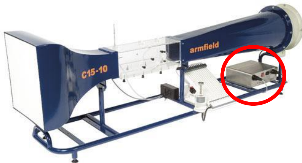
Rys. 1. Tunel aerodynamiczny C15-10
